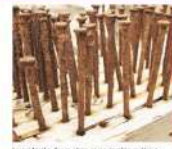
La oxidación de un clavo es un cambio químico que ocurre aunque el hierro del que está hecho y el oxígeno del aire reaccionan formando óxido de hierro.
