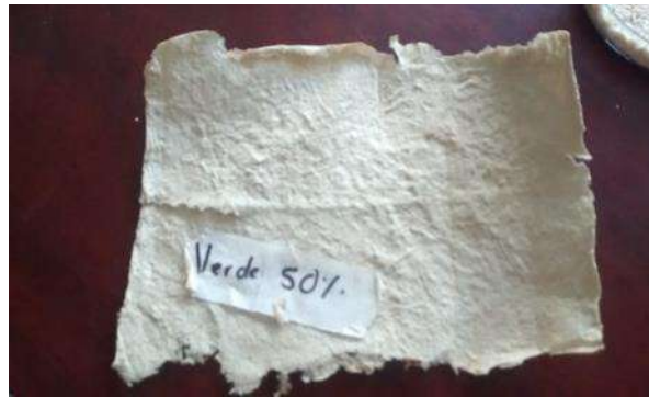
Figura 4.18 Cartón elaborado a partir de Tithonia tubiformis .
