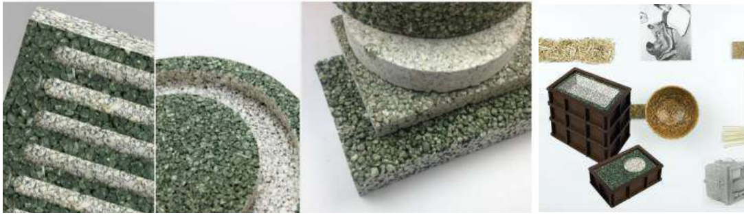
Figura 2.17 Materiales biológicos y biodegradables fabricados a partir de residuos de girasol, elaboración propia.
