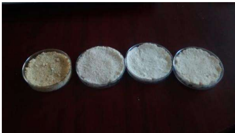
Figura 4.20 Placas moldeadas a partir de Tithonia tubiformis .
