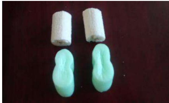
Figura 4.15 Presentación "cacahuate" de polocote (cilindros de la parte superior) y poliestireno suelto en color verde.
