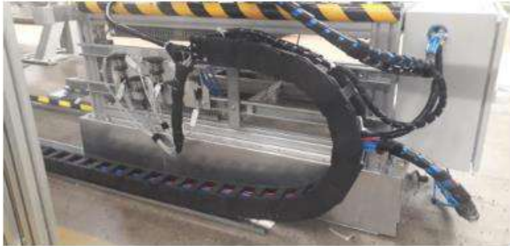
Figura 42.- Montaje de la cadena portacables.
