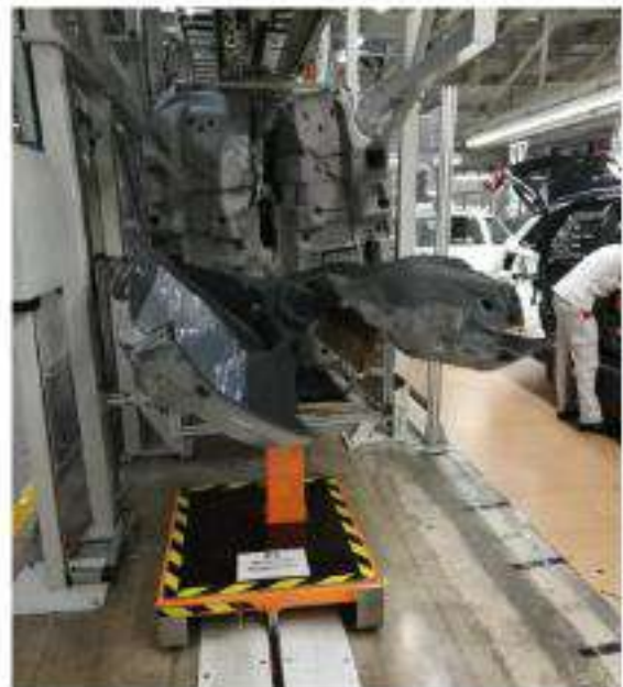
Figura 4.- Posicionamiento de alfombra en forma de V.
