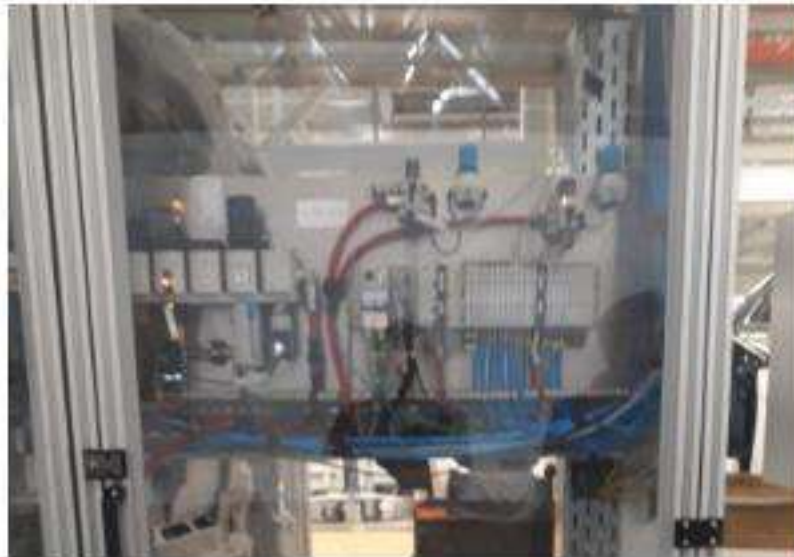
Figura 39.- Montaje y conexión de la CPX y componentes neumáticos.
