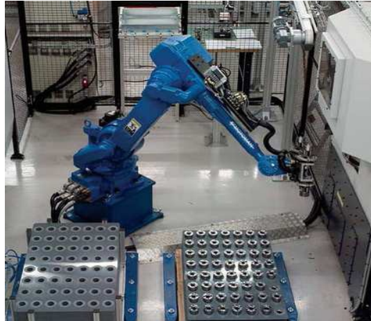
Figura 2.7 Robot Motoman Industrial tomando piezas de Torno CNC – Yaskawa - 2010 UP50N utilizado para aplicaciones de montaje 2005Bde piezas en máquinas CNC – Yaskawa 2010
