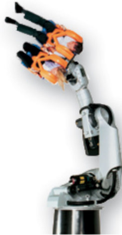
Figura 2.8 ROBOCOASTER primer robot certificado para transportar humanos KUKA Roboter-2009.
