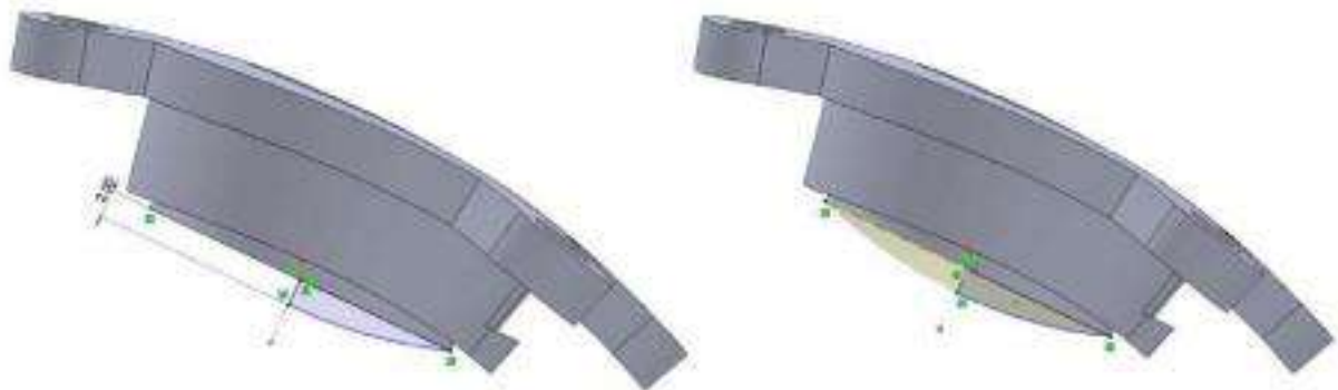
Ilustración 18: Redondeo de la superficie de contacto de los moldes
