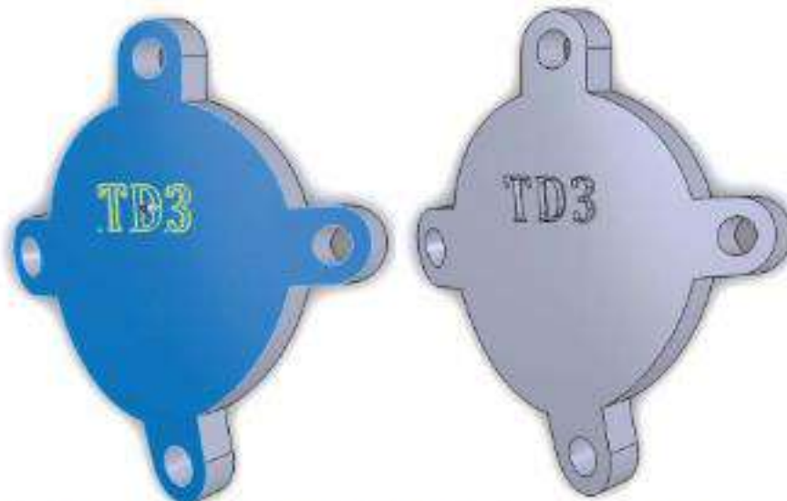
Ilustración 24: Grabado de la nomenclatura para los conectores de termoterapia
