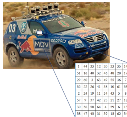
Figura 2.9: Representación de los datos (matriz de números) captados por una cámara los cuales son transmitidos y almacenados en una computadora para su futuro análisis [12].
