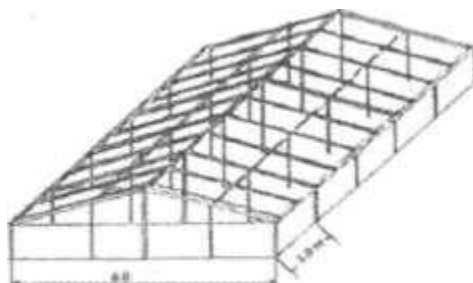
Figura 3.6. Gráfico de la estructura de un invernadero tipo Capilla.
