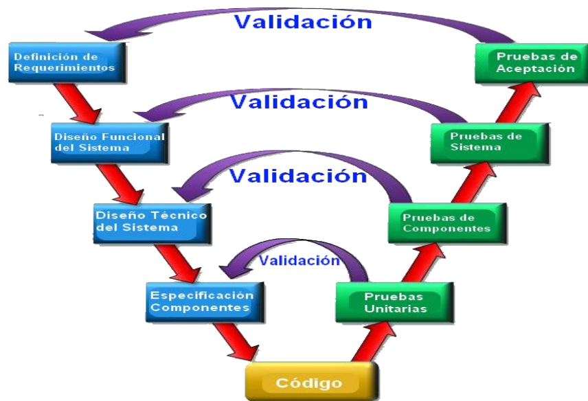
Figura 2.3 Fases del modelo en "V". Fuente: (Zheng et al. , 2014).
