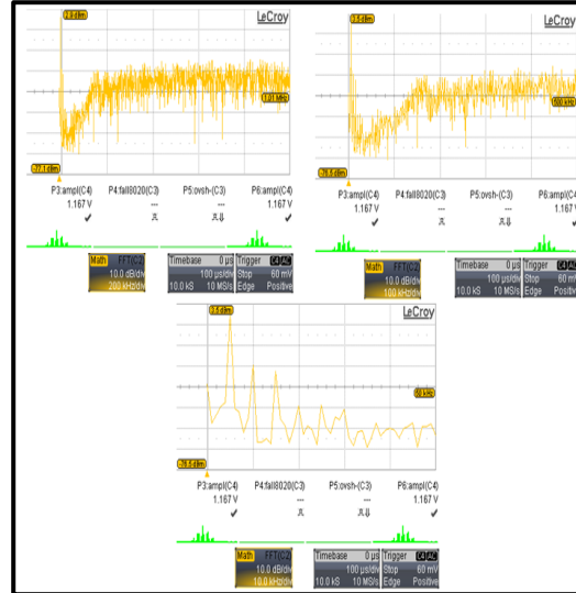
d) Espectro de salida del modulador \Sigma\Delta con Amplitud de 1.3 V pp .
