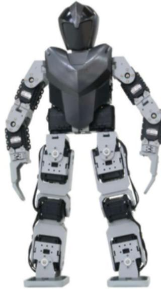
Figura 5.1: Plataforma Bioloid Premium kit Configuración tipo A
