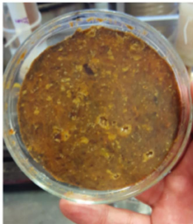
**Fig. 2.** Bioplástico fabricado usando cáscaras más madura con presencia de pigmentación debido al pardeamiento enzimático.
