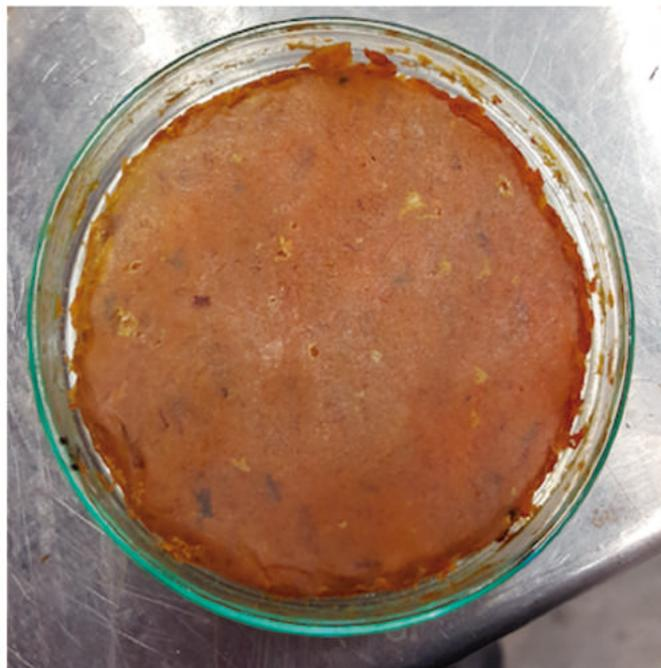
**Fig. 1.** Bioplástico fabricado usando cáscaras amarillas y sin pardeamiento enzimático.
