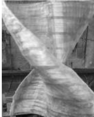
Figura 62. Aspa Savonius helicoidal fabricada en fibra de vidrio. Fuente: Propia.
