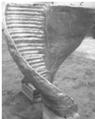
Figura 63. Aspa finalizada con capa de pintura. Fuente: Propia.
