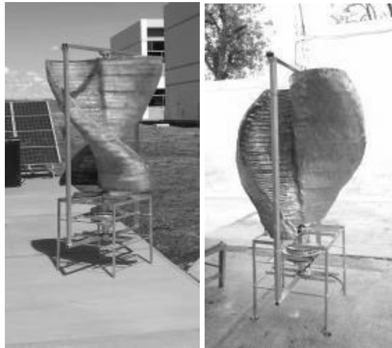
Figura 67. Ensamble de cada sección y aerogenerador detallado. Fuente: Propia.
