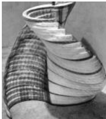
Figura 61. Recubrimiento del aspa con cinta canela. Fuente: Propia.
