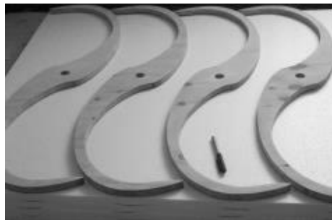
Figura 59. Aspas de madera y placas de uniel para hacer duplicados. Fuente: Propia.
