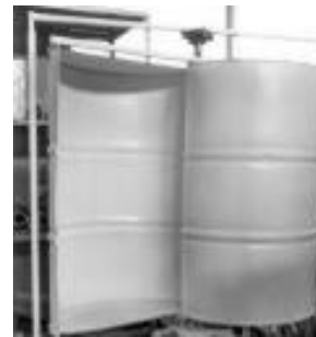
Figura 52. Rotor Savonius fabricado. Fuente: Propia.
