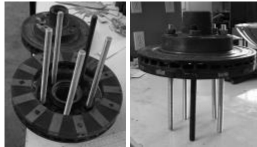
Figura 48. Espárragos en discos para fijación. Fuente: Propia.
