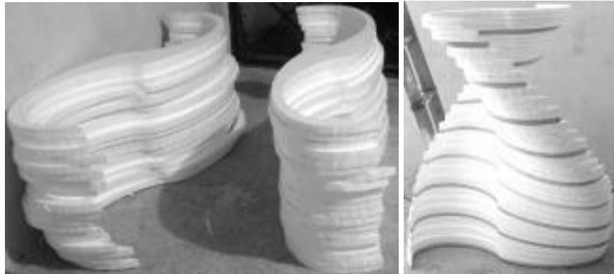
Figura 60. Aspas fabricadas en unicele y forma del álabe helicoidal. Fuente: Propia.
