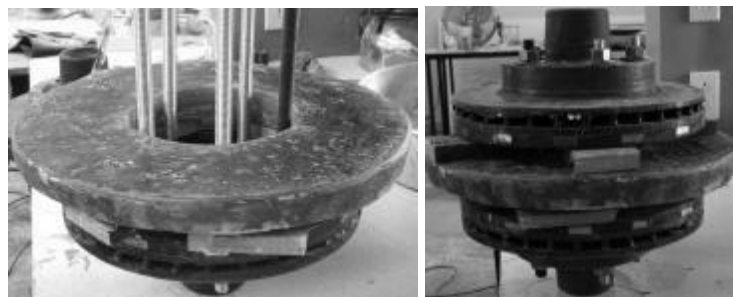
Figura 49. Estator sin fricción con los espárragos y ensamble del generador. Fuente: Propia.
