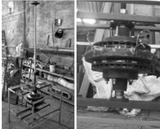
Figura 64. Base del aerogenerador con generador eléctrico montado. Fuente: Propia.
