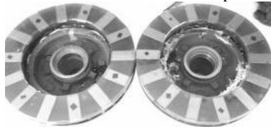
Figura 85. Rotores terminados con imanes permanentes.
