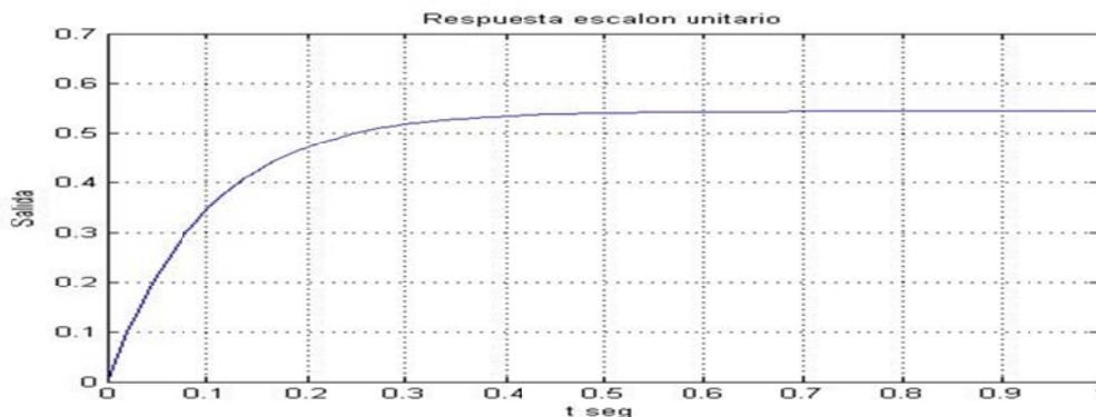
Figura 4.6 Simulación de la función de transferencia del motor izquierdo.
