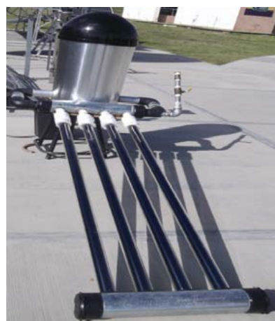
Figura 2. Calentador con tubos evacuados con separación de 0.07 m entre ellos y conectados al termotanque con aislamiento.
