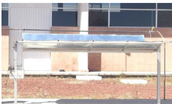
Figura 3. Concentrador parabólico con el que se trabajará para la generación de vapor
