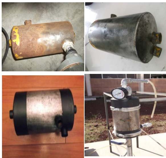
Figura 4. Limpieza y adaptación del intercambiador de calor que servirá de evaporador de paso simple, montado sobre la estructura que lo soporta, incluye conexiones de tuberías necesarias y con un manómetro.
