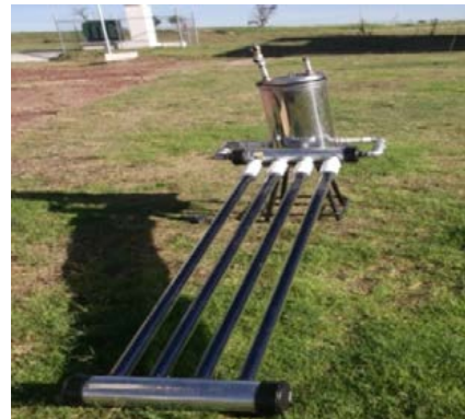
Figura 7. Colector solar de tubos evacuados sin aislamiento
