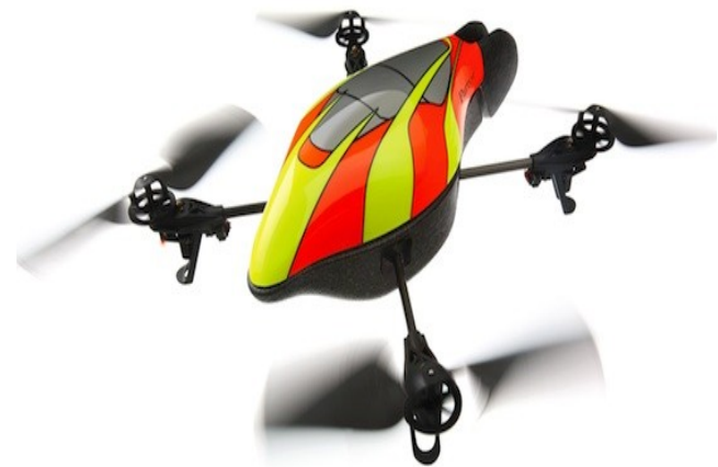
Figura 1. Robot AR.Drone: Robot aéreo tipo cuatrimotor utilizado en este proyecto [6].
