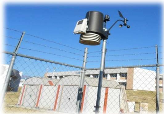
Figura 3. Anemómetro y veleta que forman parte de la estación meteorológica.
