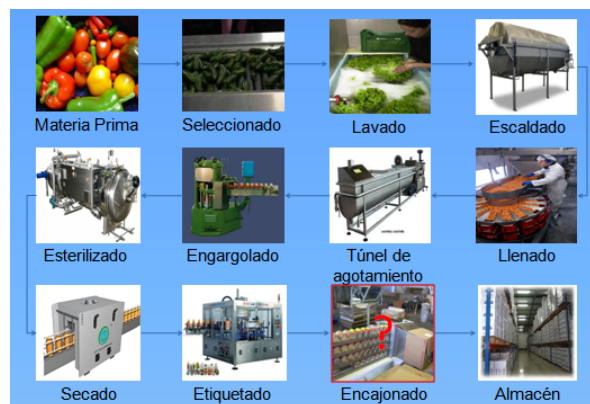
Figura 1. Línea de proceso de una empacadora de alimentos
