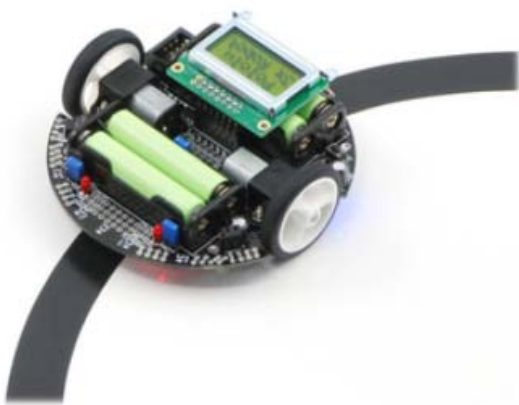
Figura. 3 El 3\pi es capaz de moverse tomando como guía la línea oscura.
