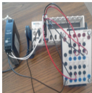
Figura 5.6: Salidas de la cDAQ a módulo de lámparas indicadoras
