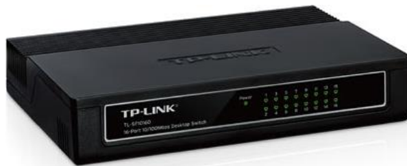
Figura 6. Switch TPLINK de 16 puertos
