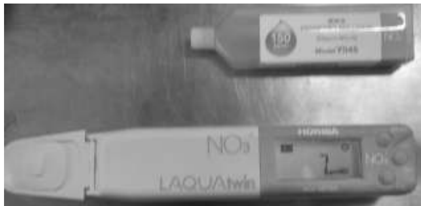
Ilustración 12: Kit LAQUAtwin con buffer 150 ppm \text{NO}_3^- .
