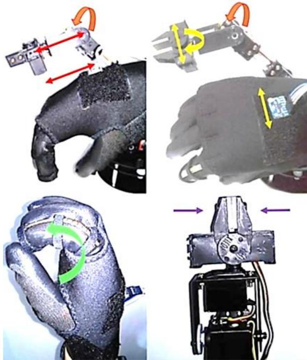
Figura 5.10 Resultados obtenidos de la teleoperación de la muñeca mediante la instrumentación de la mano con una galga extensiométrica y un giroscopio MPU6050.
