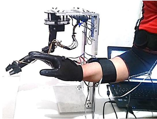
**Figura 5.12 Retraso en la teleoperación del robot, para esta prueba el retraso fue de 1.8 segundos.**
