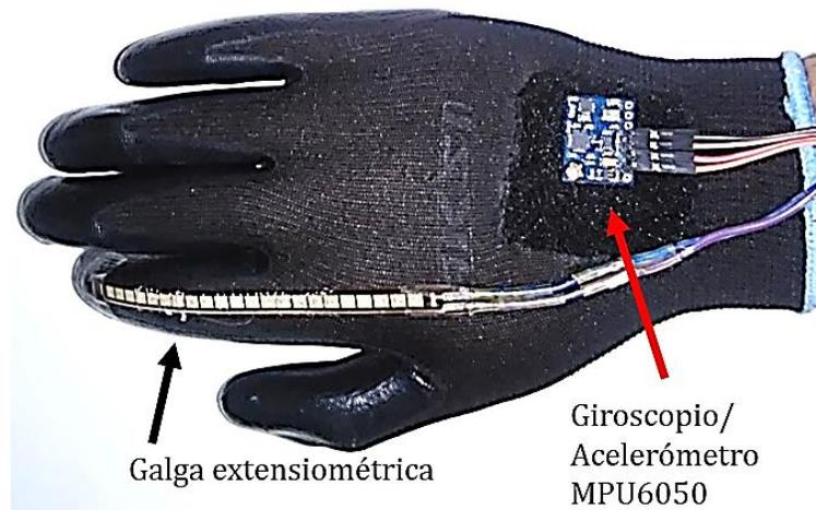
Figura 4.11 Guante instrumentado para la teleoperación del manipulador.
