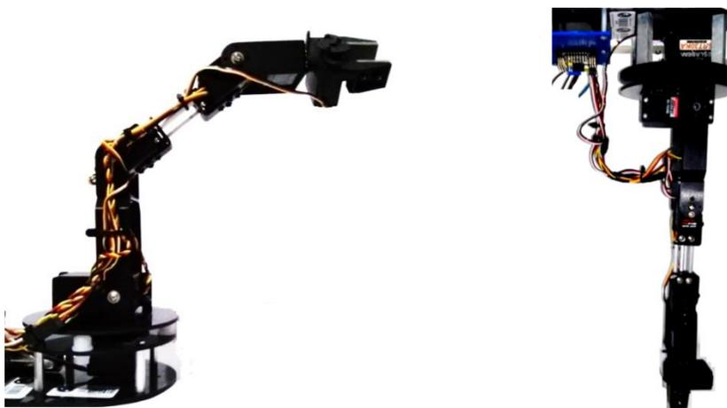
**Figura. 4.2 a) Robot manipulador de 5 GDL b) Postura que adoptara el manipulador para asemejarse al brazo humano.**
