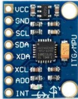
Figura. 3.17 Giroscopio-acelerómetro MPU-6050.
