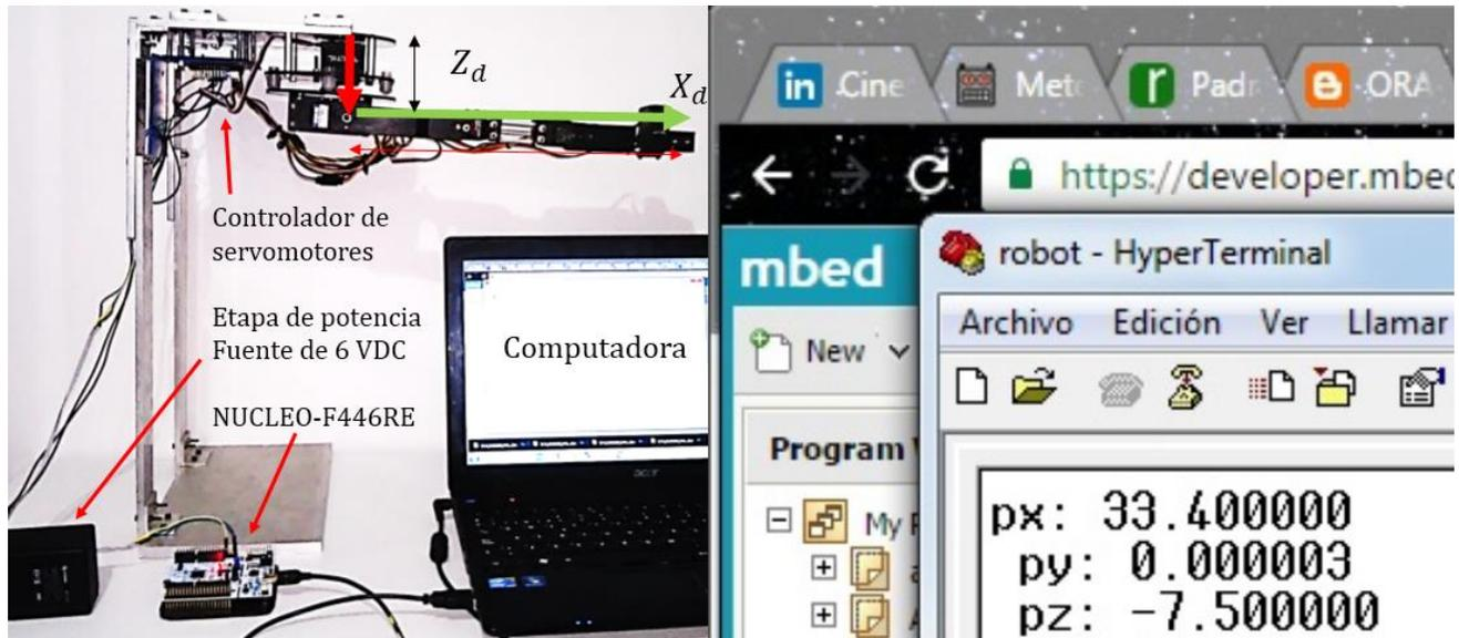
Figura 5.1 El efector final del manipulador alcanza la posición calculada por el programa la cual se puede apreciar en la hyperterminal de la computadora.
