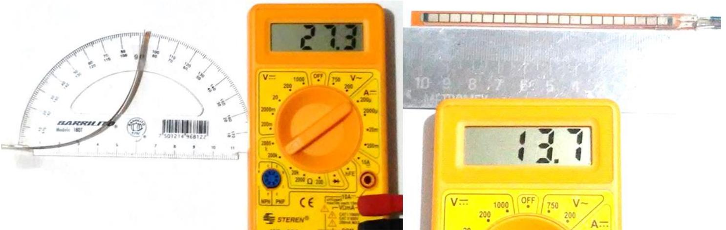
Figura 5.6 Valor resistivo máximo y mínimo de la galga extensiométrica medido con un multímetro.
