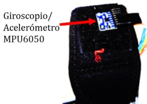
**Figura 4.13 MPU6050 para la captura de movimiento del brazo colocado en su soporte.**
