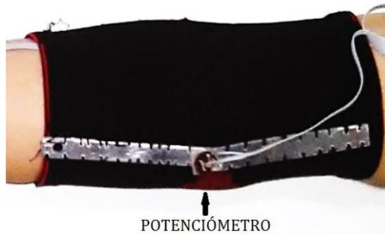
**Figura. 4.12 Potenciómetro instrumentado en el codo para el control del movimiento angular de la tercera articulación del robot.**
