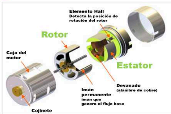
Fig. 1. Partes de motor brushless [4].
