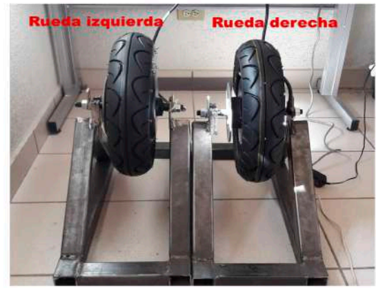
Fig. 7. Motores brushless montados en soporte fijo.
