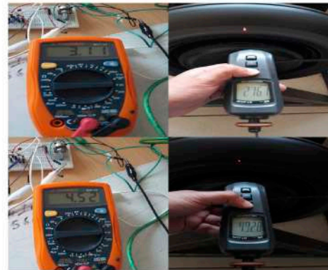
Fig. 8. Obtención de los valores de voltaje y RPM.
