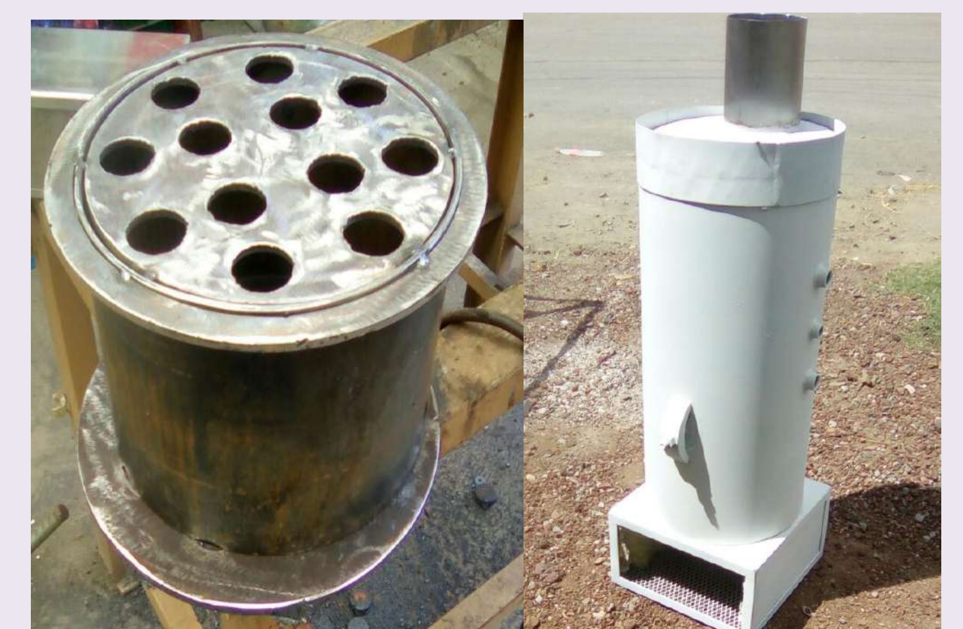
Figura 7. Estructura de la caldera de vapor de 2 C.C.
