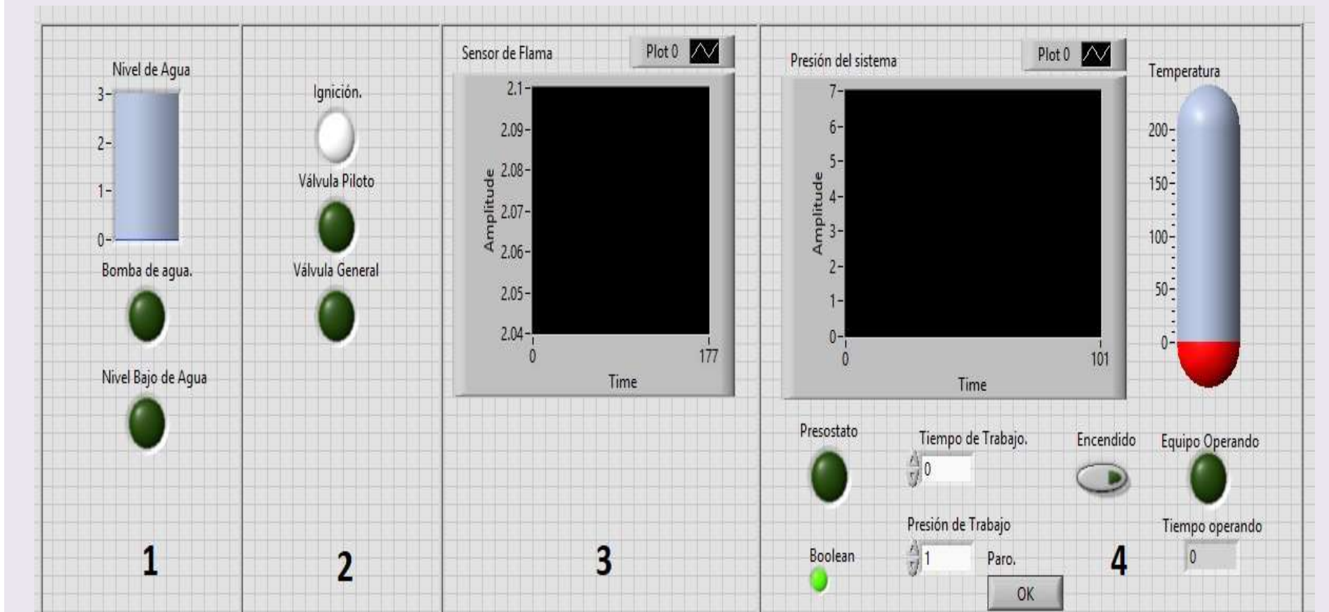
Figura 8. Interfaz gráfica del monitoreo y adquisición de datos en LabVIEW.
