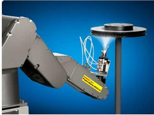
Figura 1.1: Control de posición: pintado de piezas mecánicas
