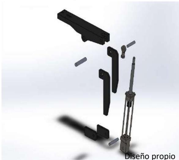
Figura 3-24: Vista explosionada de unidad de punteras.
