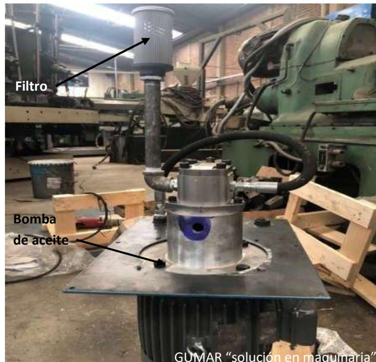
Figura 3-5: Unidad de potencia hidráulica.
