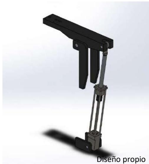
Figura 3-23: Diseño de unidad de punteras.
