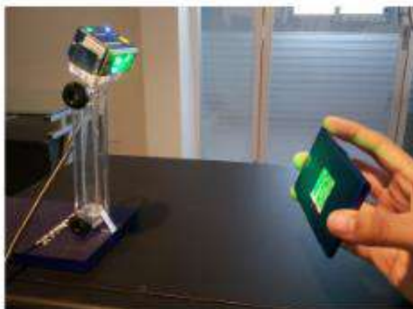
Fig. 3.20: Comprobación de buena lectura con Matrix 120
