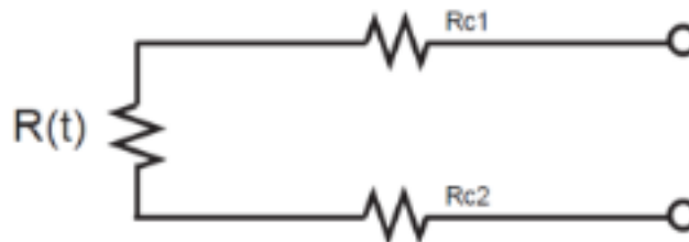
Figura 1.13: Conexión de 2 hilos en Pt100.
