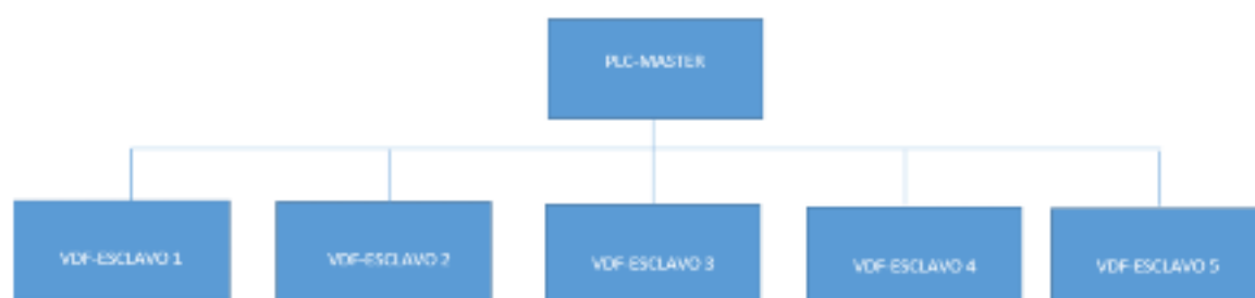
Figura 2.33: Relación entre PLC y los VDF.
