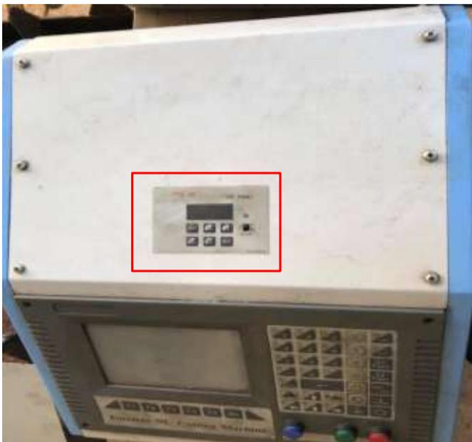
Figura 72: Controlador de altura de la antorcha.
