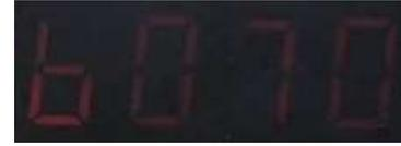
comprobar si el parámetro b tiene 70 (Figura 76). Estos parámetros van tomados de la mano y ambos sirven para el control de altura.
