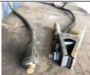
Figura 4: cable con pinza con entrada al plasma
