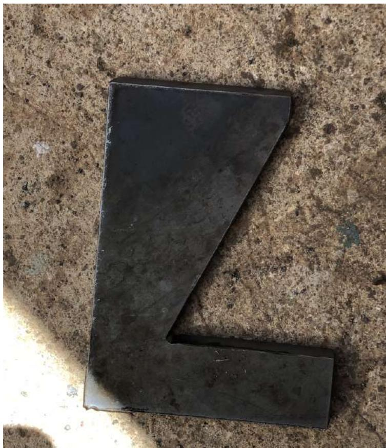
Figura 20: Pieza hecha con el pantógrafo.
