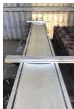
Figura 9: Riel y piezas de sujeción para riel
