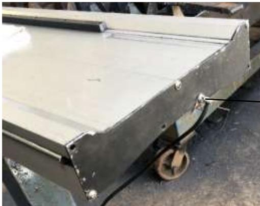
Figura 27: Conexión del riel
