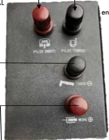
Figura 25: controlador de altura (HTC). VISTA FRONTAL
