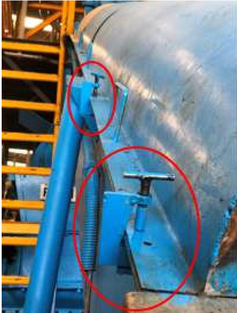
Figura 26: Colocación de clamps.
