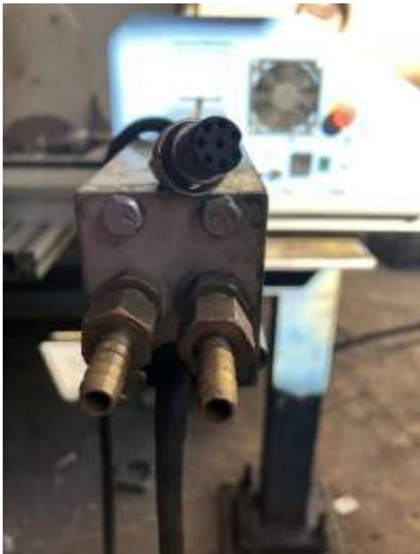
Figura 82: Conexiones para Oxicorte.
