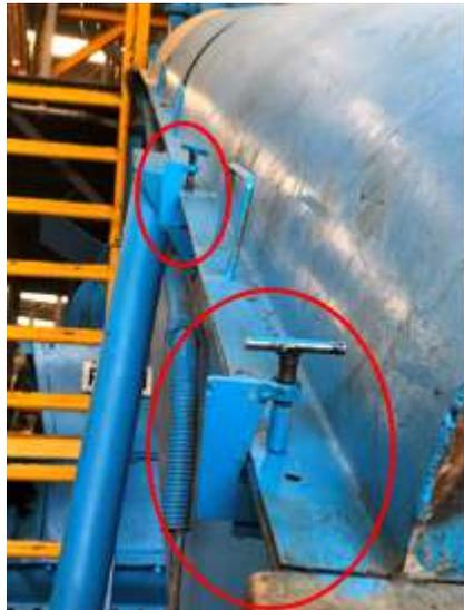
Figura 27: Implementación de los clamps en una tapa.
