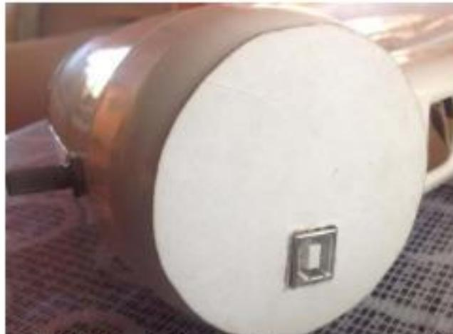
*Figura 17. Parte posterior con salida para conectar el Arduino.*
