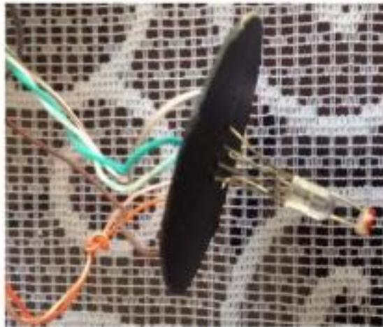
*Figura 13. Parte del circuito (Fotoresistencia y led RGB).*
