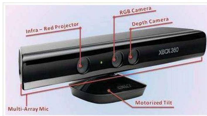
**Figura 25. Kinect componentes. [9]**
