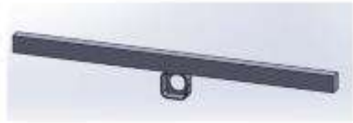
Figura 40 Soporte trasero del pistón
