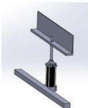
Figura 50 Ensamble del mecanismo para tope
