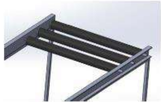
Figura 38 Colocación de los rodillos
