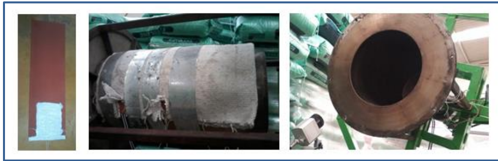
Figura 5.13 Implementación de resistencias y sensor de temperatura.
