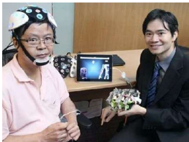
Figure 2.9: Órtesis rehabilitadora de mano con activación mediante ondas cerebrales e interfaz al usuario en un dispositivo "Ipad" [7].
