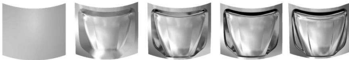
Figura 10. Proceso de formado de lámina
