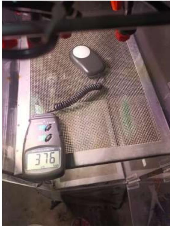
Figura 4.57 Medición de la cantidad de luz en el prototipo.
