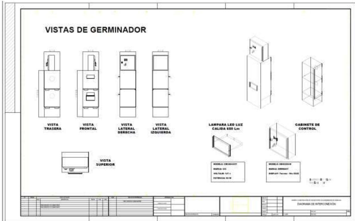
Figura 4.19 Diseño de prototipo de germinador, vistas frontal, lateral y trasera.
