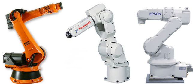
Figura 1.22: Esta figura muestra 3 robots industriales de diferentes fabricantes como el (a) robot de paletizado para carga pesada de KUKA Robotics modelo KR240270-2PA de 6 GDL, (b) el robot industrial de KAWASAKI modelo FS06N de 6 GDL para trabajos de soldadura por arco, manipulación de materiales, ensamblaje, inspección, etc. (c) El robot industrial E2 SCARA de EPSON con 6 GDL puede realizar tareas de ensamble de discos duros, ensamble de electrónico, ensamble de fibra óptica, carga y manipulación de material.
