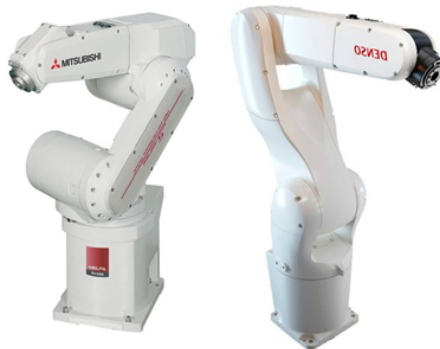
Figura 1.5: (a) Robot industrial de MITSUBISHI Electric y (b) el robot industrial de DENSO Corporation, ambos de 6GDL.
