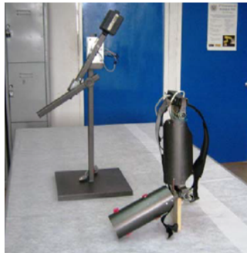
Figura 1.15: Generación de trayectorias mediante una herramienta de teleoperación.
