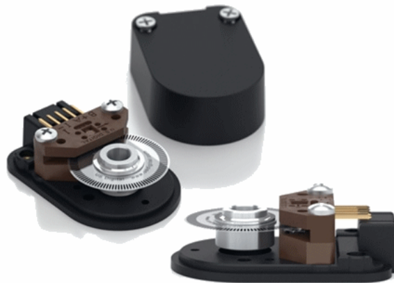
Figura 1.25: Estructura interna de un encoder incremental de cuadratura modelo HEDS-5540.
