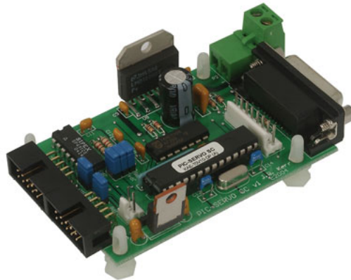
Figura 1.19: Tarjeta servocontroladora para motores de DC modelo KAE-T0V10-BDV1, será el dispositivo controlador del actuador (servomotor).
