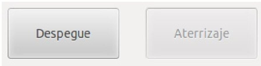
Figura 4.8: Botones para el despegue y aterrizaje del cuatrimotor. El botón de despegue eleva al cuatrimotor a una altura de un metro e inicia el envío de las lecturas de los sensores. El botón de aterrizaje envía los comandos para que el cuatrimotor aterrice sin apagar el sistema.
