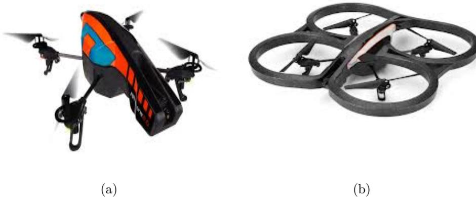
Figura 2.1: AR.Drone con carcasa de interiores (a) y carcasa de exteriores (b).
